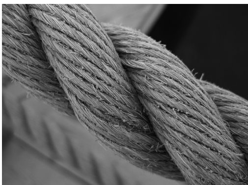
图 1-10 典型三股捻绳结构示意图
